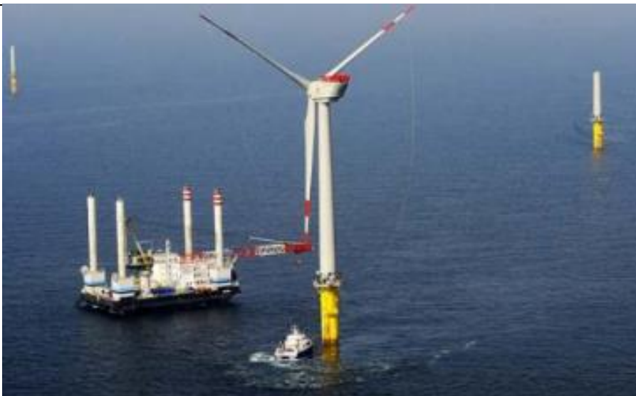
图 28: 海上安装运维船图
